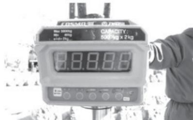
第51図 石材重量の計量器
