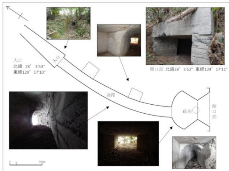
第262図 先鼻砲台(第二水平砲)跡 路測図
