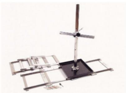
Fig. 20 レール・台車・十字型稼働装置
