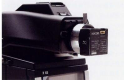
Fig. 31 ファインダーに取り付けたTVカメラ
