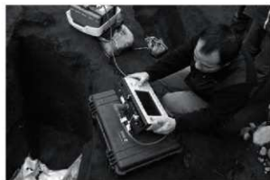
地中レーダー探査の様子②
