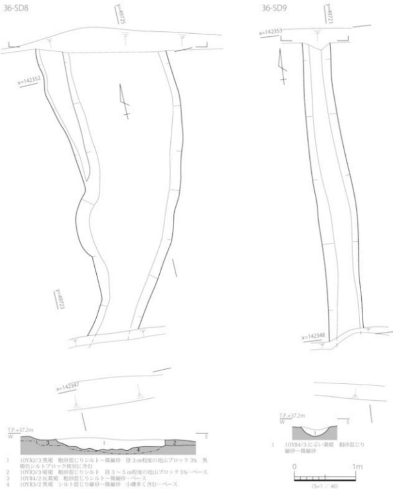
図 142 36-SD8・9 平・断面図
