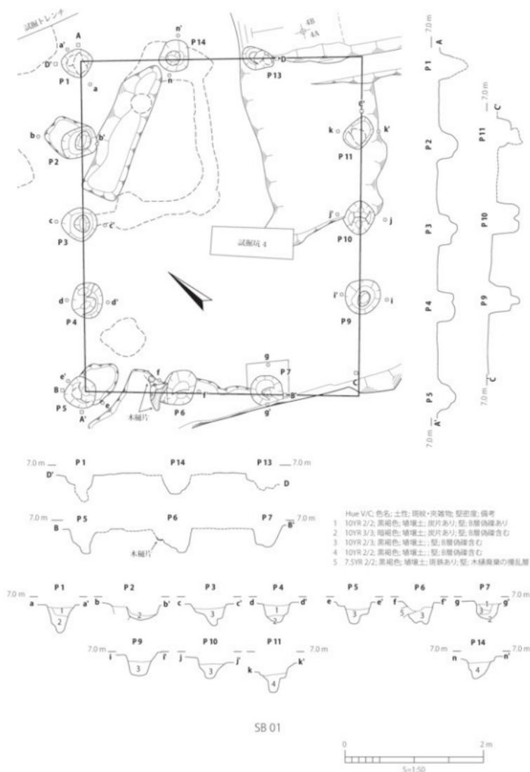
図39 符津C遺跡 掘立柱建物跡実測図
