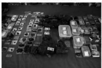
3. 14、15号炉鉄滓構成状況
