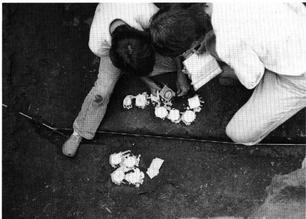
試料のサンプリング（石膏で固定し、方位を測定する）
