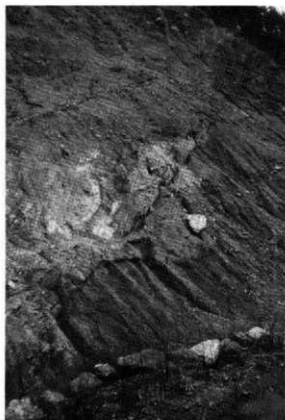
図-11 No10地点における中央構造線、図右上から左下にかけて見られる。走向：東西、北70～80傾斜の逆断層、図で上部が麻塩ミロナイト帯の圧砕岩下部は三波川帯の結晶片岩である石墨千枚岩
