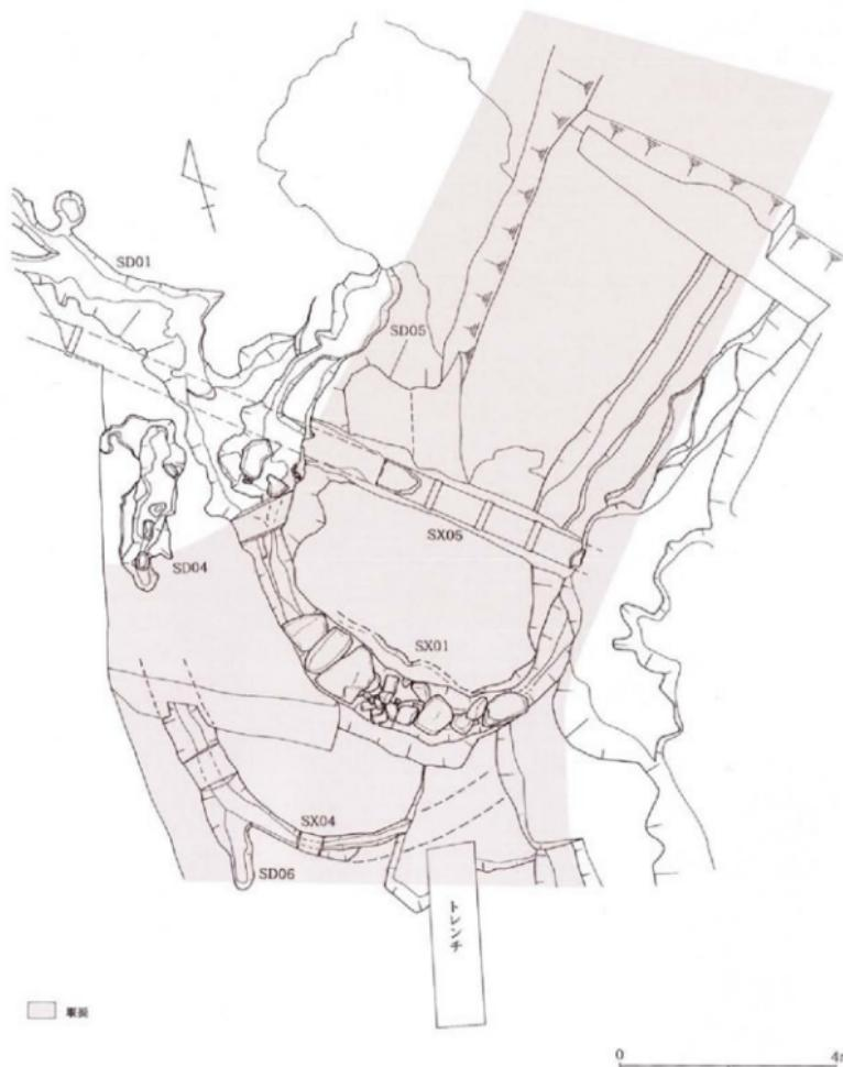
Fig. 18 暗渠SX 01 · 04 · 05 · 実測図 (縮尺1/100)
