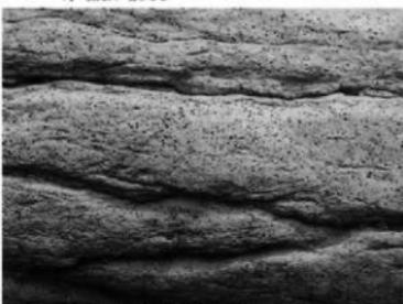
写真4 玄武岩 (図2). 細微な暗灰色の石基中に1～3 mmの黒色斑基が散在し、板状に割れる (密度は写真14と同程度)。
