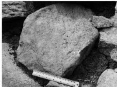
写真11 粗粒砂岩（図3）。径1~3mmの砂からなる。
