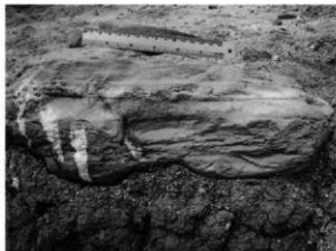
写真13 シルト岩をはさむ泥岩（図3）。シルト岩の厚さは4cmで、泥岩と比べる。
