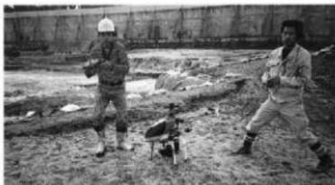
Fig. 8 ラジコンヘリコプターによる写真撮影
