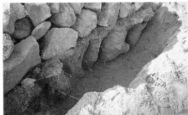
Ph.43 擬似石積み下の砂地固化試験
