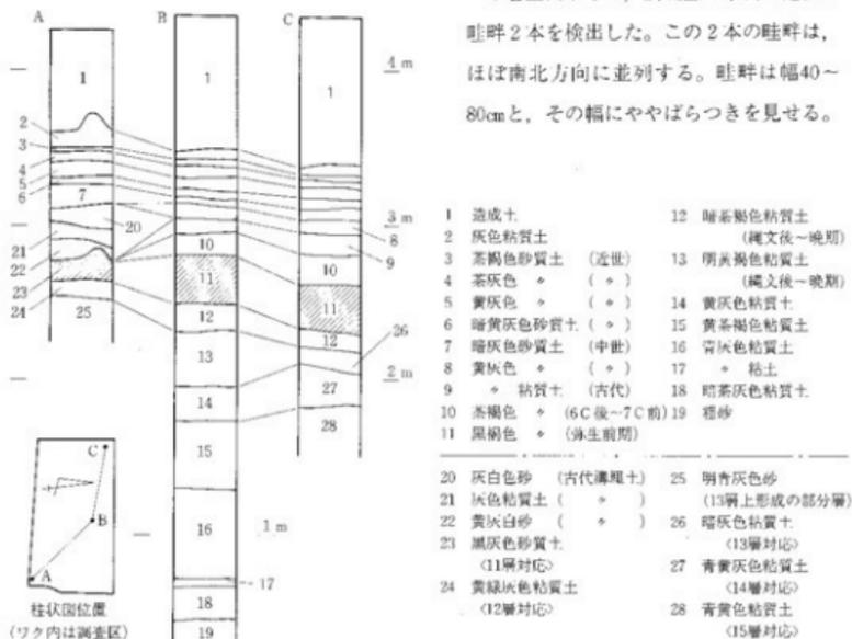
図6 土層柱状図 (縮尺1/40)
