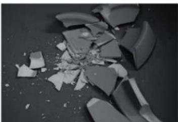
図11 硬石製ハンマーで打撃した皿を打撃した直後
