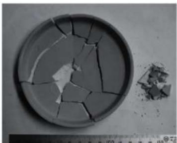
図10 カシ製棒状ハンマーで打撃した皿
