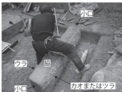
写真2 高畠石の面の呼び方
