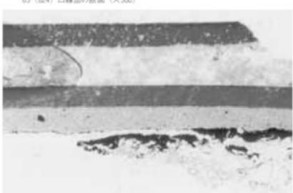
57 (834) 外面 (補修箇所の塗り重ね部分) の断面 ( $\times 300$ )
