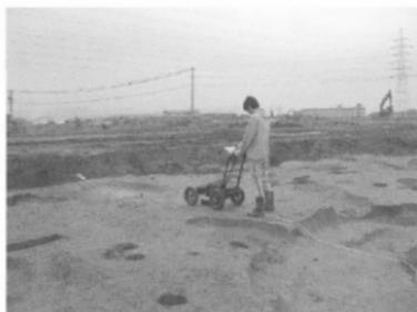
写真2 地中レーダ探査風景
