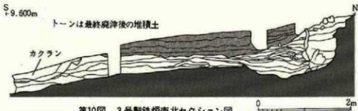
第10図 3号製鉄炉南北セクション図
