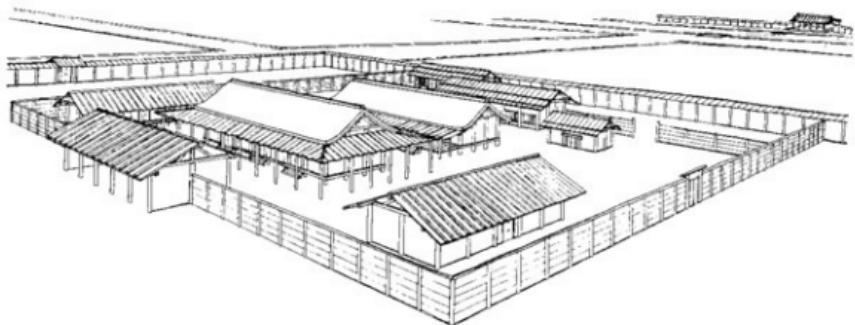
7 柱や屋根、塀などの細部を建築史の知識に基いて加筆修正した原図。これをもとに復原想像図を作成した。なお使用した機器は、16ビットコンピューター、建築バース作成ソフト、デジタイザー、XYプロッターである。
