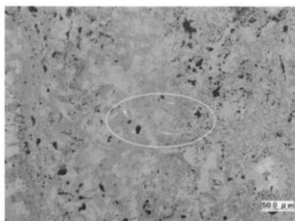
丸印内白色微結晶粒子；Cu, Ni, Co高濃度
