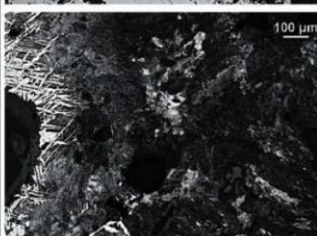
Photo.2 流動滓・鉄塊系遺物の顕微鏡組織
