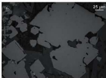
Photo.1 炉壁・流動澤の顯微鏡組織
