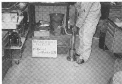
写真14 突き固めによる土の締め固め試験
