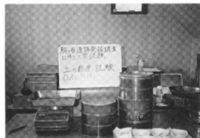
写真12 土の粒度試験 (ふるい分析)
