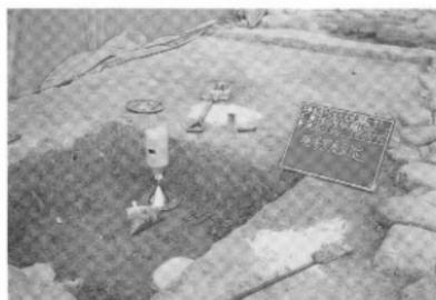
写真9 現場密度測定状況 (前方部)
