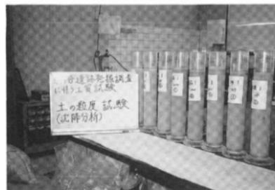
写真13 土の粒度試験 (沈降分析)
