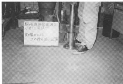
写真15 突き固めによる土の締め固め試験
