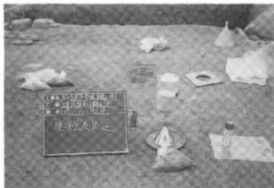
写真7 現場密度測定状況 (前方部)
