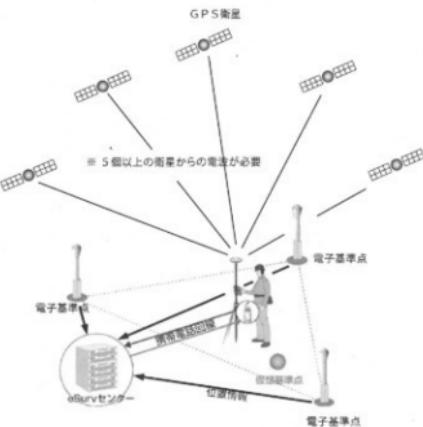
第1図 VRS-GPS測量の仕組み
