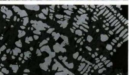
Photo. 9 炉壁溶融物と鉄滓の顕微鏡組織
