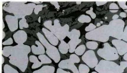
Photo.8 鉄滓の顕微鏡組織
