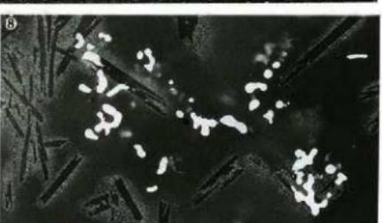
Photo. 7 炉壁溶融物の顕微鏡組織
