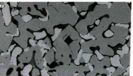
Photo. 5 鍛造刺片と炉内滓（砂鉄製錬滓）の顕微鏡組織
