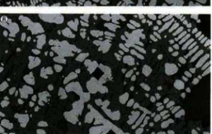
Photo. 9 炉壁溶融物と鉄滓の顕微鏡組織
