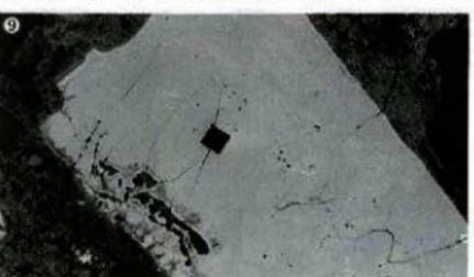
Photo. 12 不定期鍛冶津(鍛造剥片付着)(SAN-21)の顯微鏡組織
