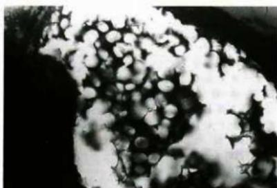
図3 付着物層断面(内底面) 600×
