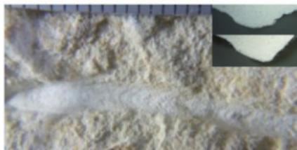
第77図 洋鉄製市販平タガネ加工面及び断面
