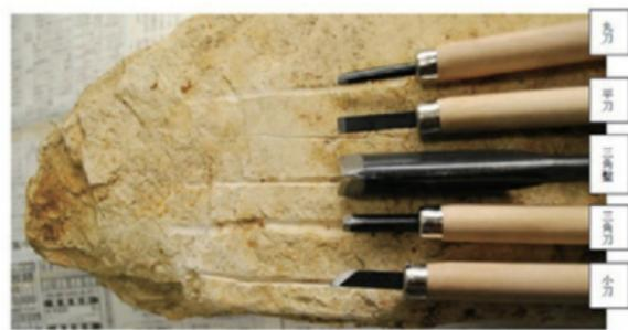
第69図 線刻工具（彫刻刀）と線刻面
