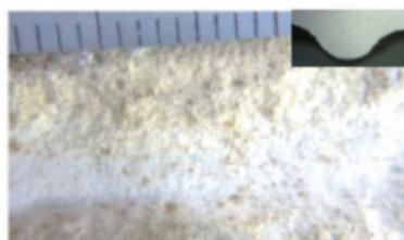
第85図 平タガネ形石工具（刃先角55°）たたき加工面
