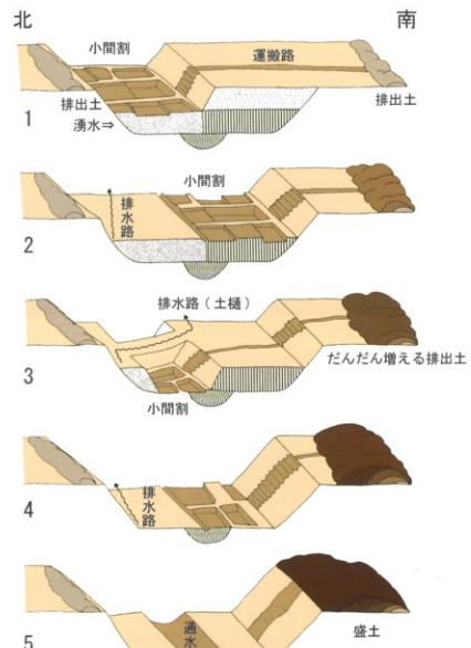
1 最初に北側を掘削する → 2 次に南側を掘削する → 3 土堰が造られる → 4 残土は南側に運ばれる → 5 通水溝をつけて完成する。
