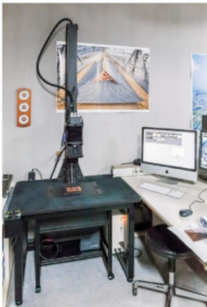
複式式高精緻写真デジタル化装置
