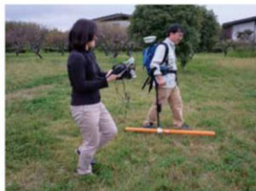
電磁探査機 CMD Mini Explorer
