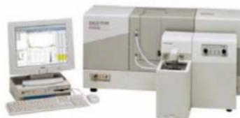
レーザー回折式粒子分布測定装置
