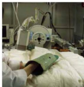
非破壊型X線回折装置 Xpert MPD
