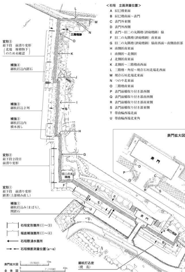
第10図 石垣変形・補強箇所と横断面・立面測量位置
