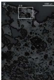
Photo.10 羽口の顕微鏡組織
