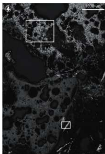
Photo. 7 梶形鍛冶滓の顕微鏡組織
