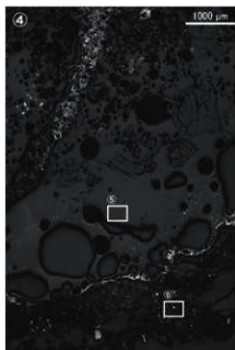
Photo.5 炉壁の顕微鏡組織
