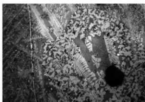
鉄滓顕微鏡組織写真 No.9-1 × 400
