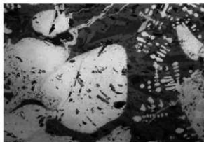
鉄滓顕微鏡組織写真 No.19-1 × 400
