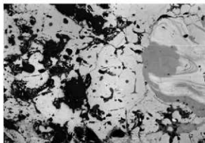
鉄滓顕微鏡組織写真 No.26-1 × 100
