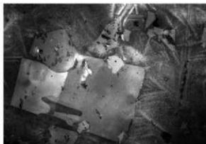
鉄滓顕微鏡組織写真 No.22-2 × 400
