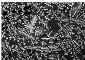
鉄滓顕微鏡組織写真 No.33-2 × 100
