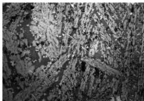
鉄滓顕微鏡組織写真 No.8-1 × 400
