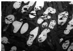
鉄滓顕微鏡組織写真 No.24-1 × 400
