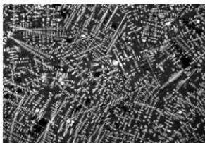
鉄滓顕微鏡組織写真 No.21-1 × 100
