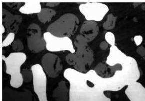
鉄滓顕微鏡組織写真 No.12-2 × 400
