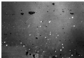
鉄滓顕微鏡組織写真 No.3-2 × 400
