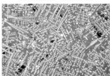
鉄滓顯微鏡組織写真 No.21-1 × 100
