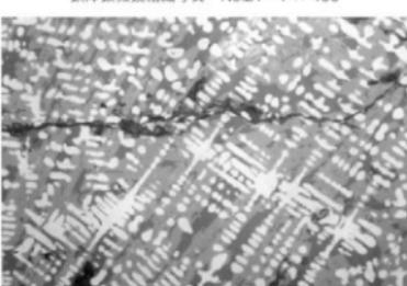
鉄滓顯微鏡組織写真 No.21-2 × 400
