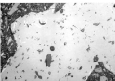
砂鉄顯微鏡組織写真 No.34-2 × 400
