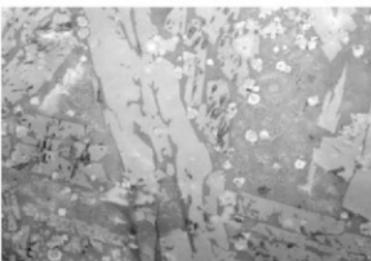
鉄滓顯微鏡組織写真 No.14-1 × 400
