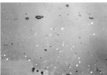
鉄滓顯微鏡組織写真 No.3-2 × 400
