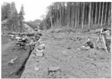
電子平板を使った実測作業
