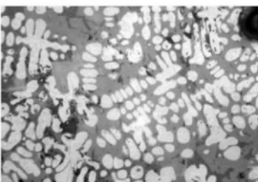
鉄滓顯微鏡組織写真 No.2-2 × 400
