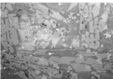
鉄滓顯微鏡組織写真 No.14-2 × 400
