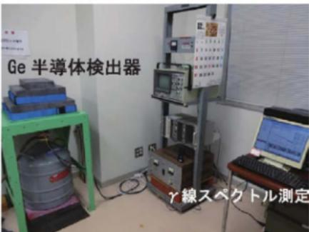
写真 2. Ge 半導体検出器とガンマ線スペクトル測定
