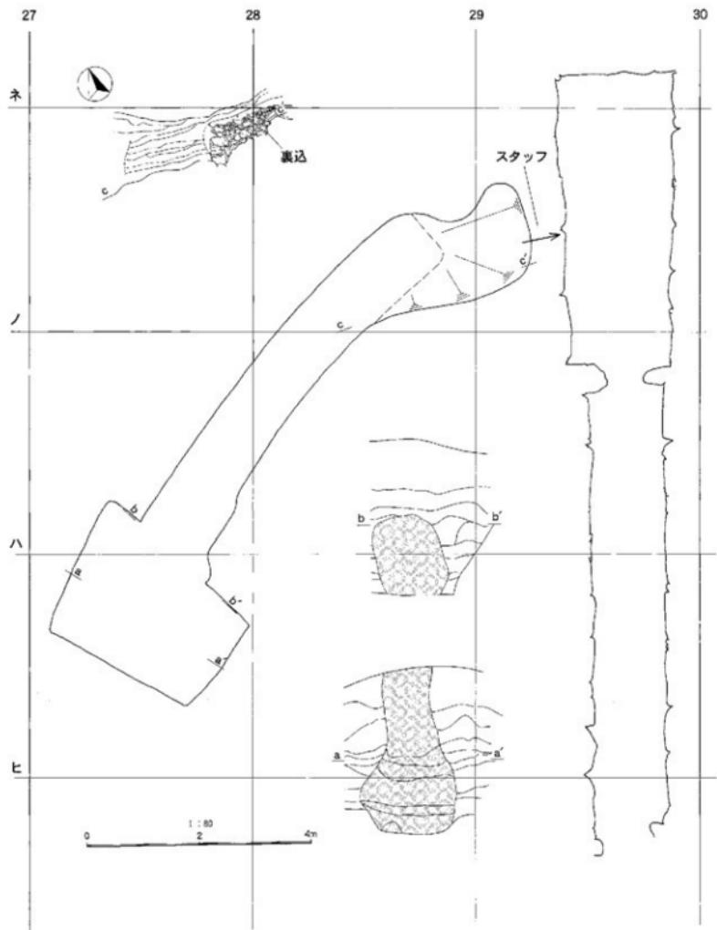
探査坑平面図・断面図
