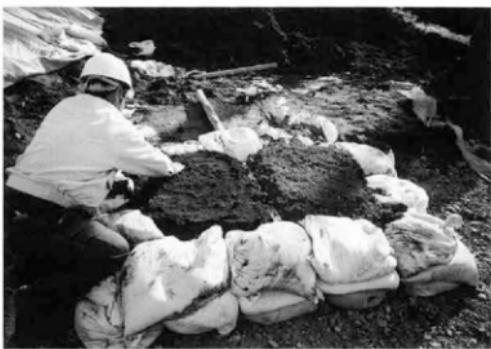
突き固め試験状況 撒き出し (左: 黒色土 右: ローム土)
