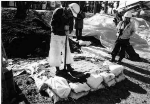
突き固め試験状況 突き固め
