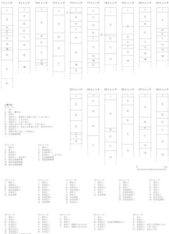
第8図 山島新田・加茂新田地区試掘調査トレンチ土層柱状図 (S=1:40)
