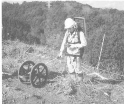
写真22 電磁法探査測定器（EM61）
