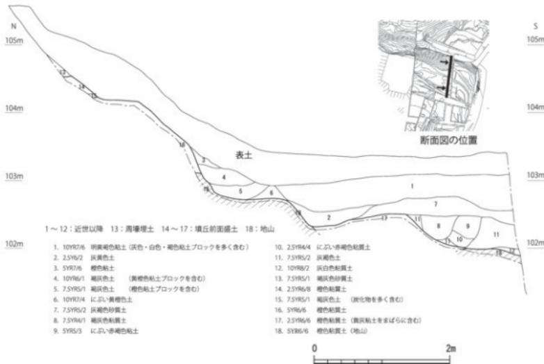
図 76 1 トレンチ中央南北畦 西面上層断面図 ( $S = 1/50$ )
