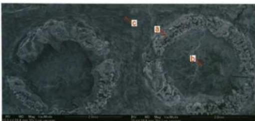
写真44 銀象嵌鋼(28)SEM像及びEDS分析位置
