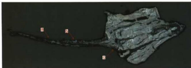
写真13 2号鞍金具後輪(16)州浜金具 断面細部観察像及UWDS分析位置
