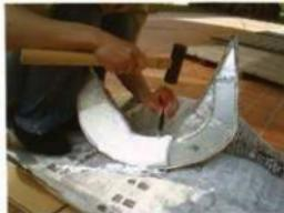
写真59 石膏型の取り外し作業
