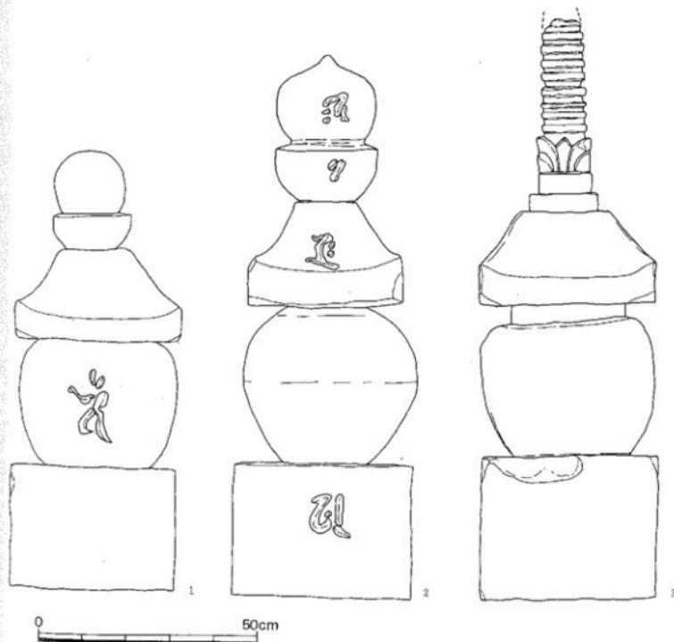
第9図 町道北側五輪塔実測図 (1 / 10)
