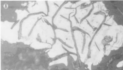
Photo. I 鉄滓と炉壁溶融物の顕微鏡組織 (外観写真 1/3.2)
