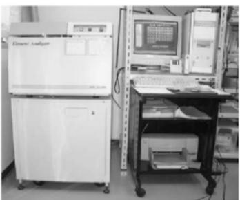
この分析装置は標準試料を必要としないファンダメンタルパラメータ法 (FP 法) による自動定量計算システムが採用されており、 $_{\text{C}} \sim _{\text{U}}$ までの元素分析が可能で、ハイパワーX線源(最大30kV、4mA)の採用で微量試料へ最大 $290\text{mm}\phi \times 80\text{mmH}$ までの大型試料の測定が可能である。小形試料では16試料自動交換機構により連続して分析できる。分析はバルク FP 法でおこなった。FP 法とは試料を構成する全元素の種類と濃度、X線源のスペクトル分布、装置の光学系、各元素の質量吸収係数など装置定数や物性値を用いて、試料から発生する各元素の理論強度を計算する方法である。
