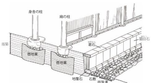
図4 基壇および基壇周辺の模式図
