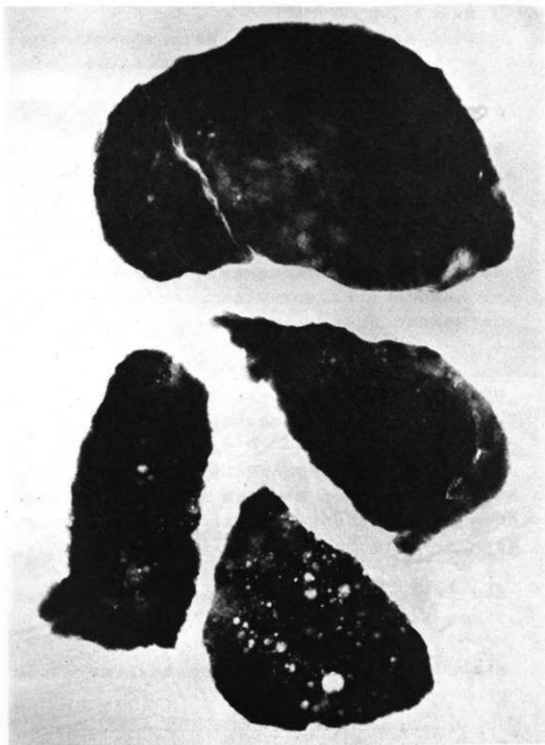
図3 鉄渣のX線透過写真
