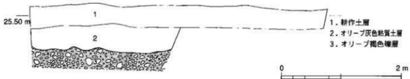
第8図 第5トレンチ土層断面実測図
