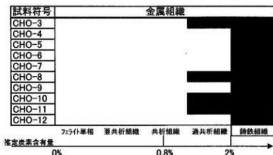
Fig.3 長源地2号製鉄遺跡出土含鉄鉄滓・鉄塊系遺物の断面金属組織観察結果
