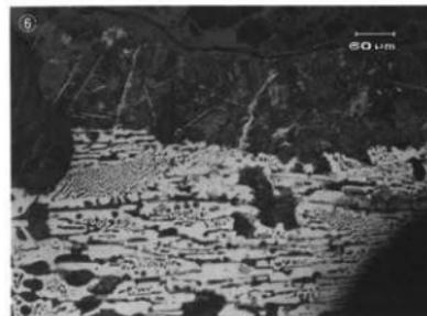
Photo.11 鉄塊系遺物の顕微鏡組織
