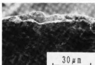
写真4：金箔の断面構造
