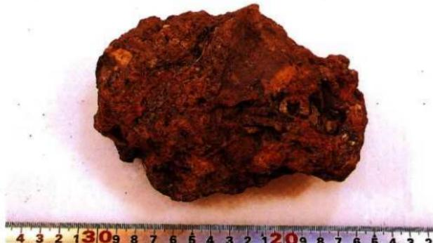
写真1 資料No.1(鉄滓)の外観写真
