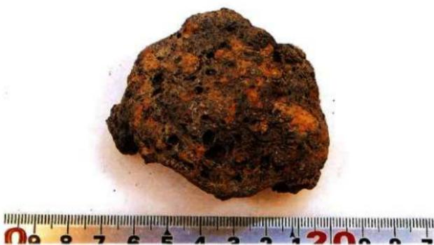
写真4 資料No.4(鉄滓)の外観写真
