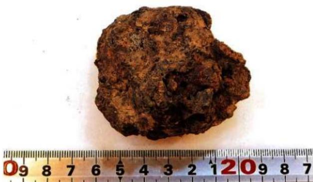
写真5 資料No.2(鉄滓)の外観写真
