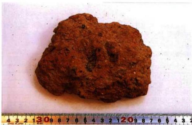
写真4 資料No.2(鉄滓)の外観写真
